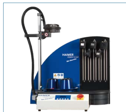
Power Clamp Profi Plus NG Hochleistungs-Schrumpfgerät – Schrumpfleistung 20 kW – Zum Schrumpfen von Werkzeugen mit \varnothing 3–50 mm – Für HSS- und HM-Werkzeuge – Große Spule für \varnothing 40–50 mm (Optional) – Inkl. Drehteller und Aufnahmehalter – Inkl. Werkzeugablage – Inkl. Schwenkfächer für Zubehör
