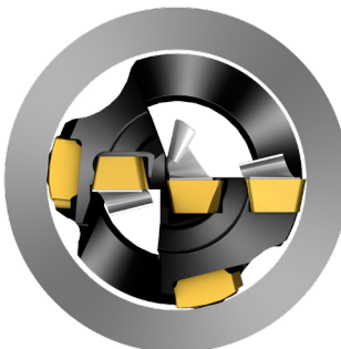
Обычно максимальный износ происходит на вершине периферийной пластины
