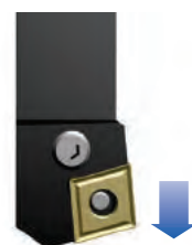
PCKN LH & RH External Square Shank Toolholders EDP Item Description Hand Insert Sizes Dimensions (mm) h = h 1 b f L 1 L 2 017130 PCKNL 2020 K 12 LH CN_1204 20 20 25 125 28 017132 PCKNL 2525 M 12 LH CN_1204 25 25 32 150 28 033280 PCKNL 3225 P 12 LH CN_1204 32 25 32 170 28 017131 PCKNR 2020 K 12 RH CN_1204 20 20 25 125 28 017133 PCKNR 2525 M 12 RH CN_1204 25 25 32 150 28 033281 PCKNR 3225 P 12 RH CN_1204 32 25 32 170 28
