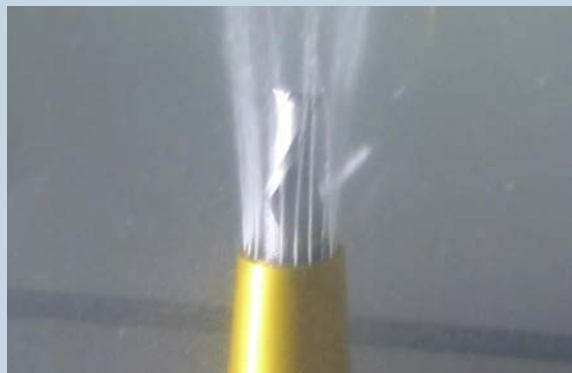
Aufsteckhülse mit Düsen – ineffektive Kühlung, Kühlmittel gelangt nicht zur Schneide Насадки с соплами – неэффективное охлаждение, СОЖ не достигает режущей кромки
