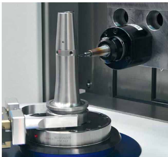
Автоматическое удаление дисбаланса при помощи блока чпу Automatic removal of imbalance by CNC processing unit
