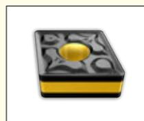
Двухсторонняя пластина с положительными передними углами, позволяющими избежать деформации. Передний угол изменяется вдоль режущей кромки на отрицательный, чтобы предотвратить скалывание. Специальная конструкция позволяет уменьшить кратерный износ. Для углеродистой и легированной стали, нержавеющей стали и жаропрочных сплавов.
