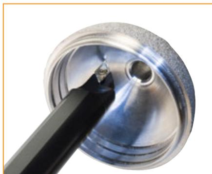
Эти расточные резцы были спроектированы главным образом для обработки дна отверстий или вогнутых сферических поверхностей, таких как протезы коленной чашечки.
