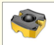
Двухсторонняя пластина с острой режущей кромкой и положительным передним углом стружколома 16°. Для обработки жаропрочных сплавов на глубину  $ap < 3$  мм.
