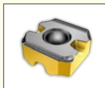
Двухсторонняя пластина с острой режущей кромкой и положительным передним углом стружколома 13°
