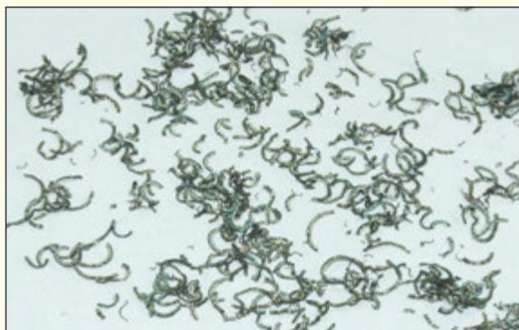
При точении твёрдых материалов образуется длинная и запутанная стружка. Стружколомы HF и HM обеспечивают превосходное стружкодробление на различной глубине резания.
