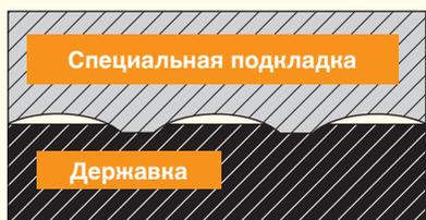
Центр пластины находится ниже режущей кромки. Такая геометрия обеспечивает оптимальный отвод стружки при черновой обработке. Уникальная геометрия пластины позволяет использовать её с обеих сторон. В сравнении с пластиной аналогичного размера CNMM, эта пластина имеет в три раза больше режущих кромок. Пластины, см. стр. В132.
