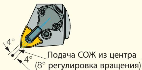
Для установки или замены пластины: нажмите на трубку и вдавите её в корпус насадки.
