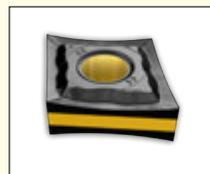
Двухсторонняя пластина с большим положительным передним углом, и острыми положительными радиальными режущими кромками. Для жаропрочных сплавов, нержавеющей стали, алюминиевых сплавов, и мягкой низкоуглеродистой стали.
