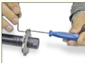
Используйте короткую сторону ключа для окончательной затяжки и расслабления винта крепления
