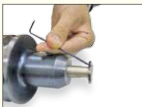
Используйте длинную сторону ключа для предварительного затягивания или выкручивания уже расслабленного винта
