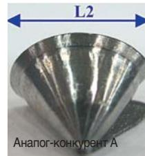
Элемент стружки, имеющей малые радиусы деформации, сформированный ступенчатой режущей кромкой и стружколомом, обеспечивает стабильный отвод стружки.
