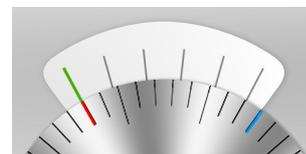
825 - Регулировка диаметра по нониусу с точностью 0,002 мм (0,00008"). Один оборот (360°) изменяет диаметр на 0,5 мм (0,020"). Диапазон регулировки диаметра на чистой расточной головке: 15 мм (0,590").
