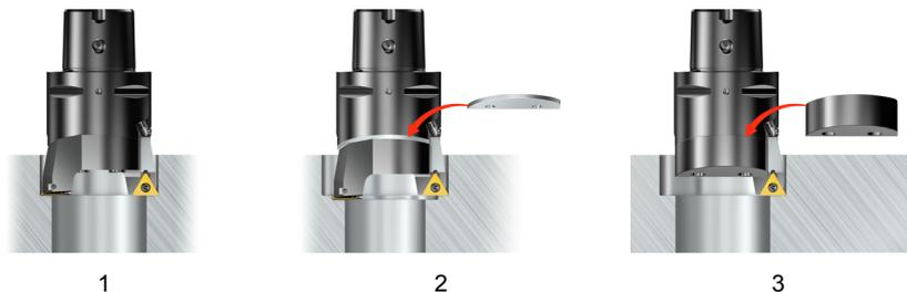
1. Растачивание двумя режущими кромками
