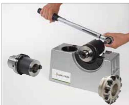
7. Затянуть динамометрическим ключом.
