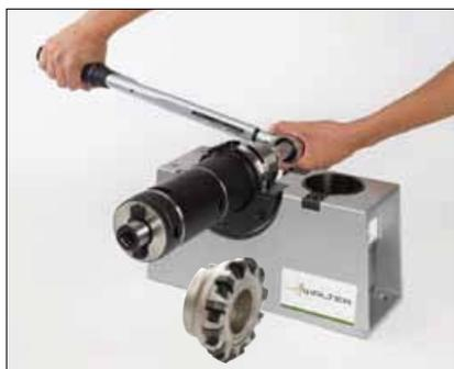
10. Затянуть динамометрическим ключом.
