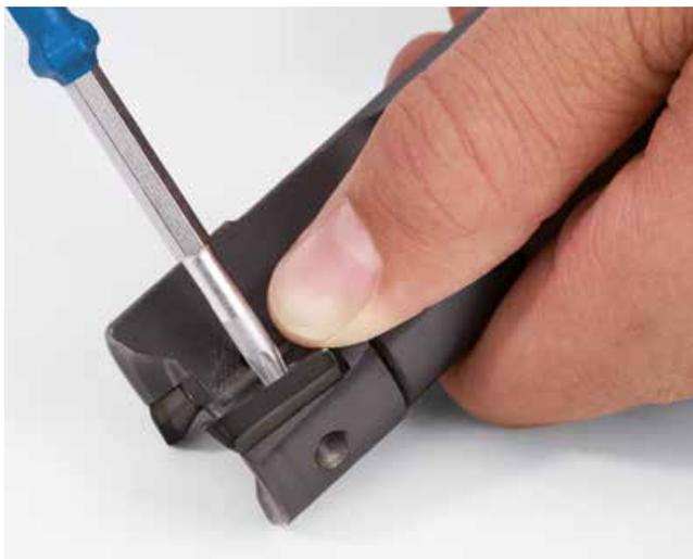
Проверьте установку с помощью прокладки толщиной 0,01 мм
