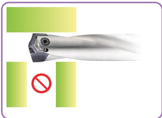
Размер пересекаемого отверстия превышает высоту пластины сверла.
