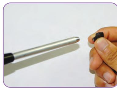
Очистить поверхность пластины и гнездо под пластину в корпусе сверла.
